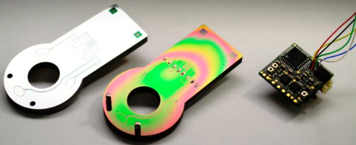
3 Fertigungsstadien des sensorischen Unterlegscheibensystems mit Bluetooth Low Energy Datenübertragung
